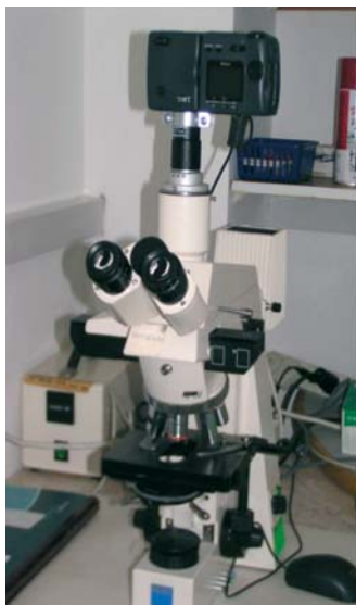
Rys. 10. Mikroskop fluorescencyjny i obserwowany w nim obraz komórki epidermy liścia. Obraz ten powstaje dzięki autofluorescencji chlorofilu
