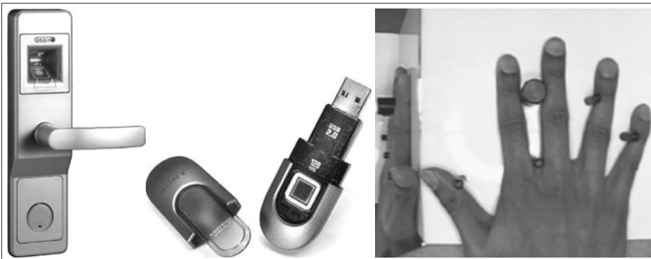
Rys. 2. Zamek do drzwi i pamięć masowa z czytnikami odcisku palca, pomiar kształtu dłoni
