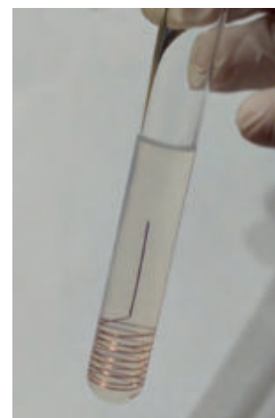
Fot. 5 – Drut w próbówce z żelem
