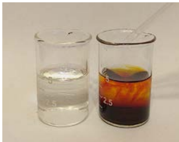
Fot. 14 – Wykrywanie nadtlenu wodoru za pomocą zakwaszonego roztworu jodku; po lewej – przed dodaniem nadtlenu, po prawej – dodatni wynik próby
