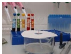
Rysunek 10. Ilustracje obrazujące przebieg doświadczenia. Rozwijanie chromatogramu sposobem odśrodkowym. Numery od 1 do 4, przypisane poszczególnym zdjęciom odpowiadają kolejnym etapom wykonania ćwiczenia.
