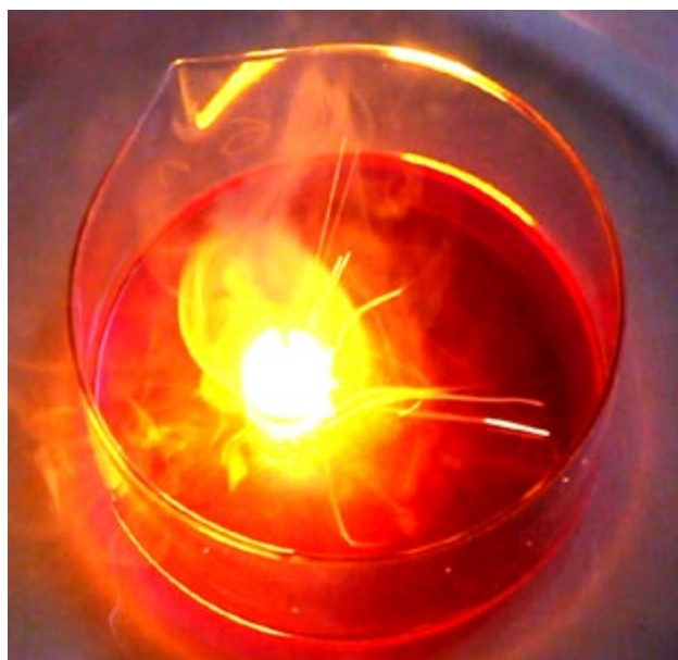
Fot. 1 – Zapłon sodu w reakcji z wodą
