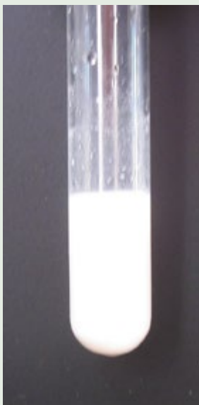
Po dodaniu roztworu kwasu fosforowego(V) do roztworu wodorotlenku litu wytrąca się obfity osad.
