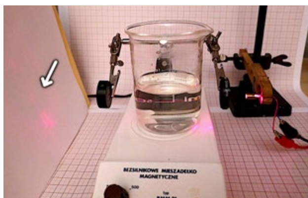
Fot. 7 – Zanik plamki świetlnej po wstawieniu naczynia z roztworem cukru (zaznaczono strzałką)
