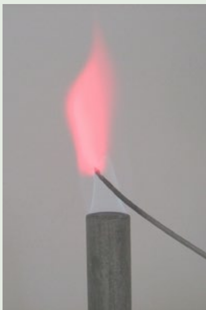
Próbka litu w płomieniu palnika.
