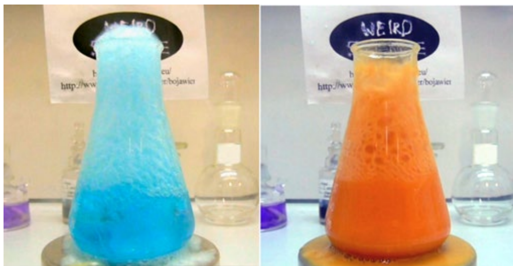
Fot. 7 – Efekt zastosowania zbyt małego naczynia lub zbyt dużej objętości roztworów
