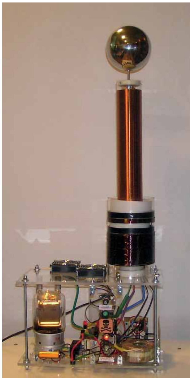
Foto 5. Transformator Tesli zbudowany przez inż. Jarosława Nowakowskiego (ze zbiorów WFTIMS PG)
