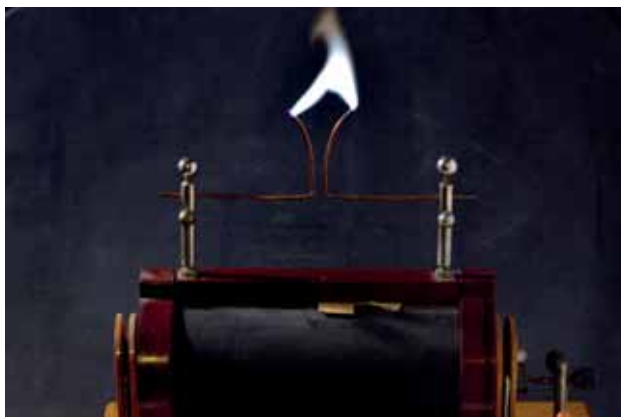
Foto 9. Łuk elektryczny wysokonapięciowy
