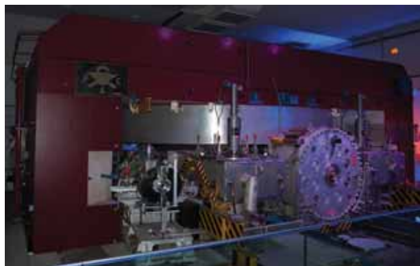
Fot. 1. Synchrocyclotron był pierwszym akceleratorem zainstalowanym w CERN. Przyspieszał cząstki do maksymalnej energii 600 MeV, służąc eksperymentom naukowym przez 33 lata.
