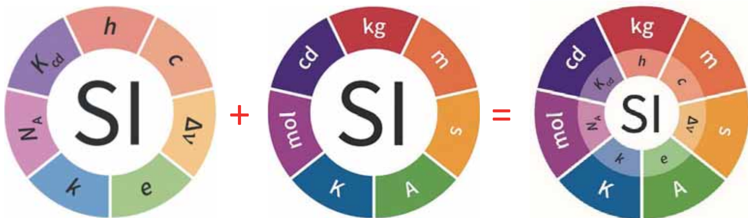
Rysunek 1. Nowa koncepcja SI. Ustalenie wartości 7. stałych podstawowych i powiązanie tych stałych z siedmioma podstawowymi jednostkami miar.
