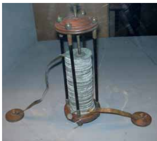
Ryc. 4a) Oryginalne ogniwo Volty z Muzeum w Como: stosik par krążków cynkowych i miedzianych, przełożonych filcem zwilżonym kwasem. b) To samo muzeum – dwa ogniwa „stosy” i bateria szklane, połączonych elektrycznie (płytki cynkowe i miedziane). Foto: GK; Tempio Voltiano, Como.
