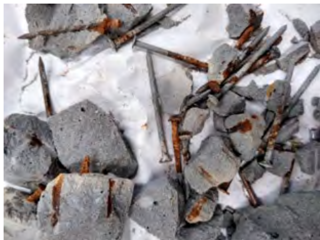
Fot. 4. Stalowe gwoździe po ośmiu tygodniach pozostawania w betonie będącym w kontakcie z 10% roztworem soli kuchennej (fot. SP nr 359 w Warszawie).
