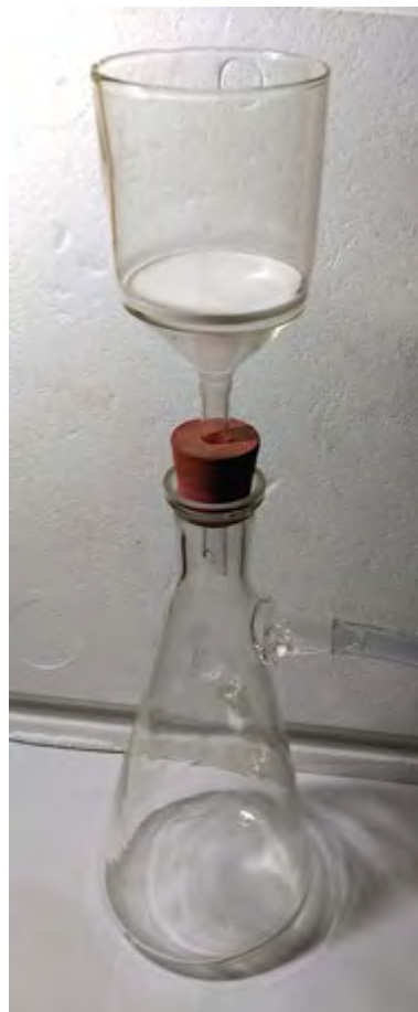
Fot. 5. Zestaw do sączenia pod obniżonym ciśnieniem
