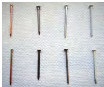
Fot. 1. Od lewej: stal miedziana, stal, stal polerowana, stal pokryta lakierem. Na dole próbki poddane procesowi korozji.
