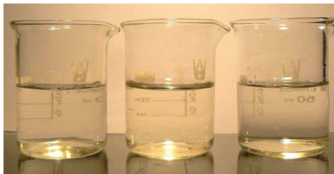
Fot. 3 – Trzy zlewki, jedna z nich zawiera rozcieńczony roztwór rywanolu, pozostałe wodę destylowaną
