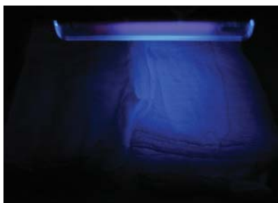
Doświadczenie 2. Widok gazy niepranej (z lewej) i pranej w proszku z wybielaczami optycznymi po oświetleniu nadfioletem.
