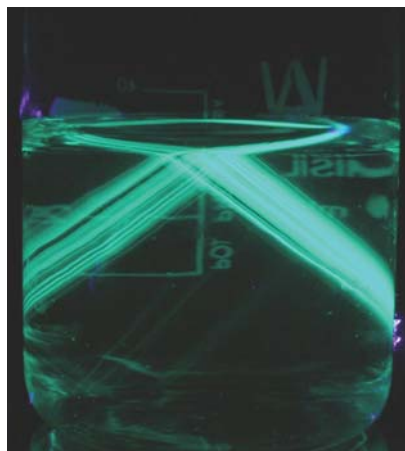
Fot. 5 – Wewnętrzne odbicie promienia lasera w roztworze rywanolu
