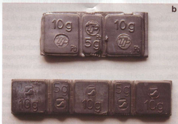
Rys. 2. Ołowiane, nielegalne obciążniki do kót. (a): od góry obciążniki o masach: 65 g, 55 g, 40 g, 35 g, 30 g, 20 g, 10 g, 5 g; (b): ołowiane obciążniki do felg aluminiowych o masie 5 i 10 g.
