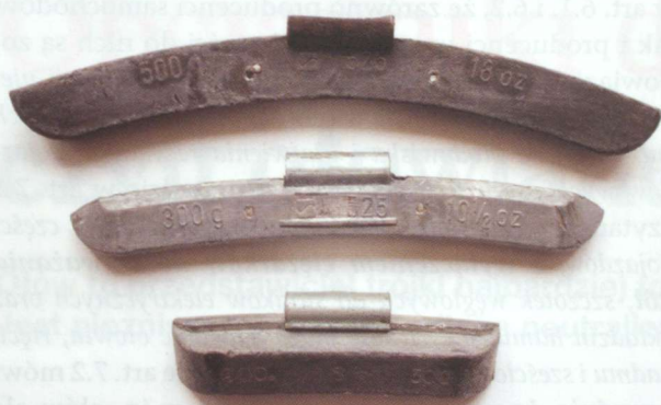
Rys. 1. Ołowiowe, nielegalne obciążniki do kót. Od góry obciążniki o masach: 500 g, 300 g, 300 g.
