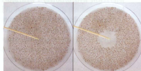
Doświadczenie 6. Ruch drobin kawy pod wpływem zmian wartości napięcia powierzchniowego wody
