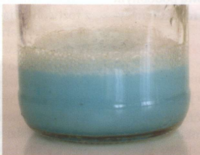
Fot. 3. Burzliwa reakcja opiłków miedzianych z kwasem octowym i nadtlenkiem wodoru (widoczne są pęcherzyki wydzielającego się tlenu)
