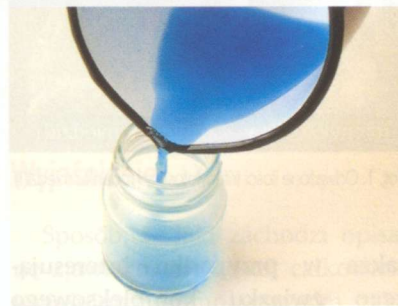
Fot. 7. Przelewanie resztek roztworu po odparowaniu do stoika, w którym zajdzie krystalizacja
