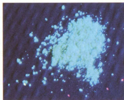
Fot. 5. Kompleks [Cu(NCS)(py)_2(PPh_3)] ; widoczna bardzo jasna fluorescencja pod wpływem światła UV (ISO400, czas naświetlania: 1/30s)
