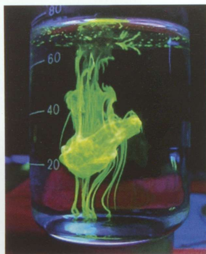
Fot. 1. Fluoresceina rozpuszczająca się w wodzie z dodatkiem wodorotlenku sodu. Wyraźnie widoczna żółtozielona fluorescencja
