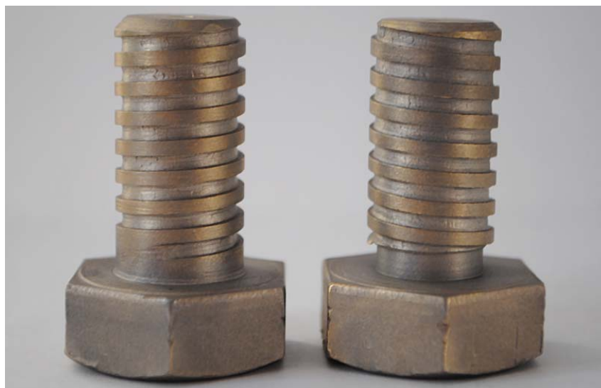
Rys. 7. Układ: para śrub z prawym i lewym gwintem
