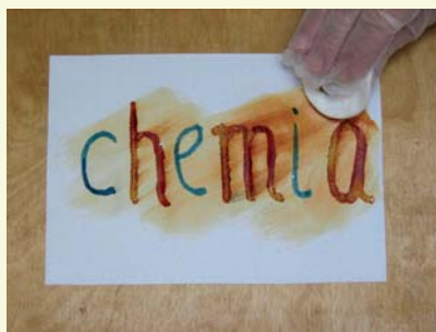
Fot. 6. Tekst sporządzony roztworami heksacyjanożelazianu(II) potasu oraz rodanku potasu po wywołaniu roztworem chlorku żelaza(III) ujawnia się w postaci dwubarwnego napisu
