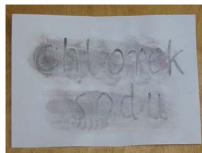
Fot. 7. Napis sporządzony roztworem chlorku sodu, wywołany roztworem azotan(V) srebra i wystawiony na działanie światła słonecznego
