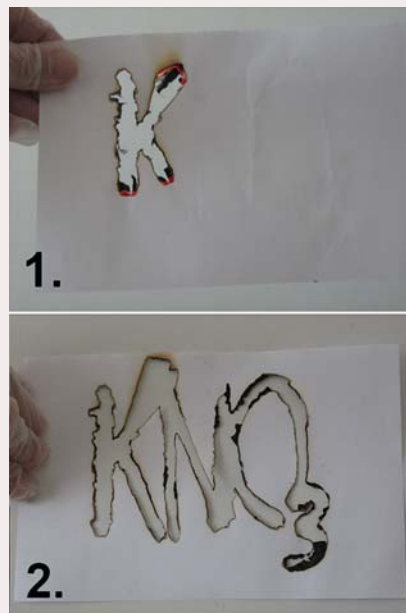
Fot. 10. Do kartki papieru z napisem sporządzonym roztworem azotanu(V) potasu przykładamy rozgrzaną główkę gwoździa. Od tego miejsca rozprzestrzenia się żarząca ścieżka (1), która ujawnia ukrytą treść (2)
