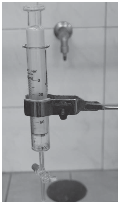
Fot. 2. Otrzymywanie gazów w próbniku
