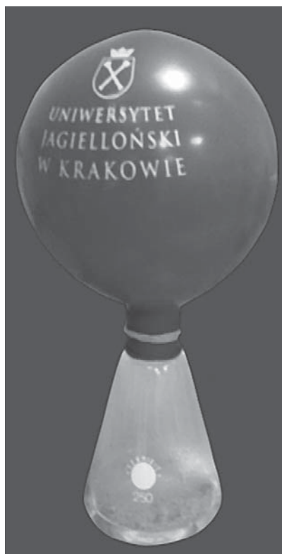
Fot. 1. Otrzymywanie gazów w kolbie płaskodennej
