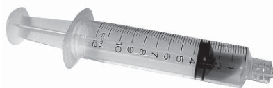
Fot. 3. Przykład strzykawki z podziałką, którą można zastosować w doświadczeniach, w czasie których otrzymuje się gazy
