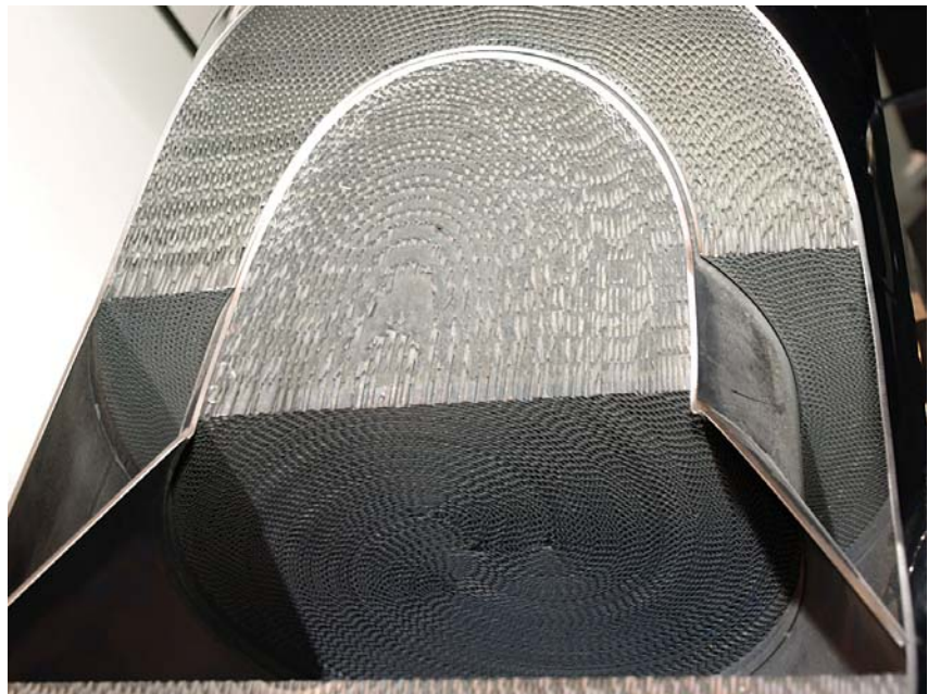
Fot. 2. Budowa wewnętrzna katalizatora samochodowego
