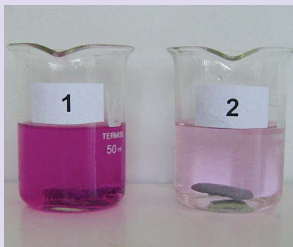
W zlewkach znajduje się roztwór kwasu siarkowego(VI) wraz z dodatkiem manganianu(VII) potasu, a w zlewce 2. dodatkowo niewielka ilość azotanu(V) potasu. Po wrzuceniu granulek cynku do zlewki, zawartość naczynia z dodatkiem azotanu(V) potasu szybko się odbarwia
